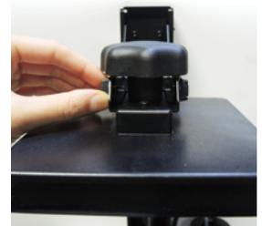
Tras aflojar los tornillos, pulse OK y espere hasta que la plataforma descienda hasta el fondo.
