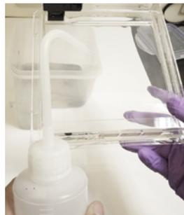
④ Rocíe el depósito y el acabado de silicio y espere 1 minuto aproximadamente. Raspe cualquier residuo suavemente y tire el alcohol restante del depósito a la basura. Repita el paso hasta que se hayan quitado todos los residuos.
