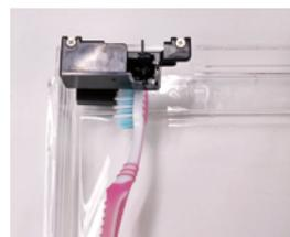
③ Limpie el sensor del nivel del depósito si se atora. Enjuague el sensor con alcohol o frótelos con cuidado con un cepillo suave.
