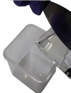
① Tire la resina sin fraguar del depósito a la basura. Para la resina restante, raspe la superficie del depósito suavemente mientras extrae el líquido.
