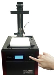
④ Levante la plataforma: En la pantalla de la impresora, seleccione "UTILITIES" (UTILIDADES) y presione ► para ir a "MOVE PLATFORM" (MOVER LA PLATAFORMA) > "TO TOP" (HACIA ARRIBA). Y presione "YES" (SÍ) para levantar la plataforma.
