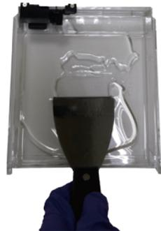
② Raspe suavemente los residuos adheridos al depósito. Evite dañar el acabado de silicio.
