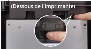
② Ponga a un lado la impresora y libere la carcasa del módulo de impresión empujándola hacia la derecha. Siga los procedimientos para extraer la espuma protectora ubicada debajo de la plataforma.
