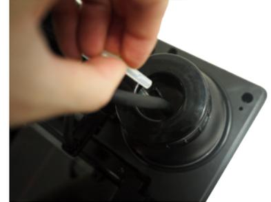
⑩ Instale los tubos de relleno. Empuje los tubos completamente. Acople primero el tubo negro (grosso) en la boquilla ancha y, a continuación, una el tubo transparente (fino) a la boquilla estrecha.
