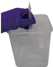
③ Enjuague la parte afectada con alcohol ( $\geq 75\%$  de alcohol) Vierta alcohol en el depósito de enjuague, agite el objeto impreso durante 10 minutos y frótelos con los dedos completamente.
