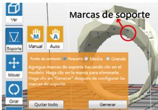
**Edición manual:** puede agregar o eliminar estructura de soporte manualmente basándose en las características de la impresión. Para agregar soporte, simplemente seleccione un tamaño de punto de contacto adecuado y, a continuación, haga clic en el modelo en la parte superior del lugar donde se necesita el soporte hacia abajo. Para eliminar el soporte, simplemente haga clic en la marca de soporte. Después de configurar las marcas de soporte, haga clic en "Generate" (Generar) para continuar.
